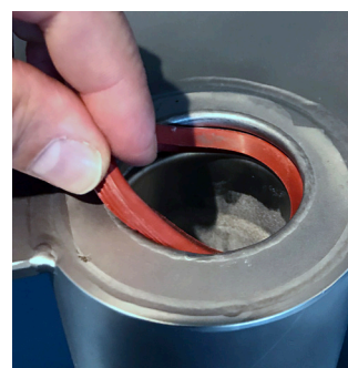
4) 装置密封件，定要按正确的方向安装
